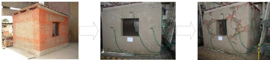
شکل ۶- آرایش تقویت با تورهای پلاستیکی و بررسی رفتار لرزه ای در دو فاز
